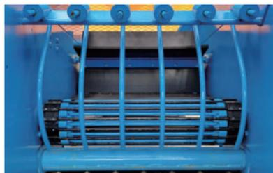
機内に入った莖葉は第2コンベアとスナッピングローラーの間から機外へ排出されます。
