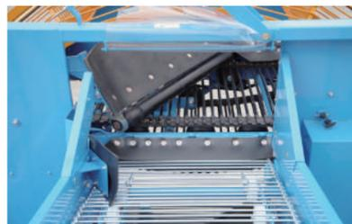
さらに第3コンベアでも処理しきれなかった土砂と莖葉はサイドコンベアと強制ローラーで綺麗に処理します。
