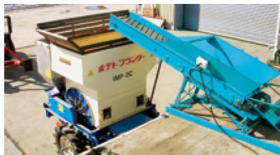
種芋はミニコンから供給コンベアのホッパーに投入して、プランターに供給します。
